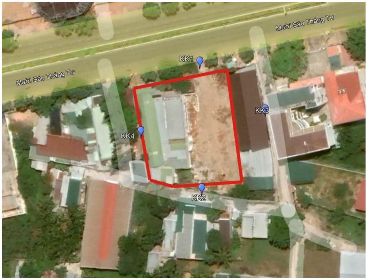
Hình 6. 1: Sơ đồ vị trí giám sát môi trường không khí trong giai đoạn thi công 6.2.2 . Kế hoạch quan trắc trong giai đoạn vận hành
